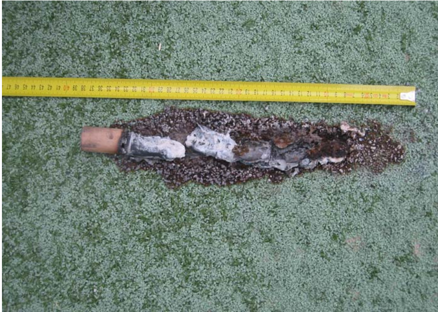
figure 1: Test with firework („bengalisches Feuer“) – EPDM rubber infill - damaged area
