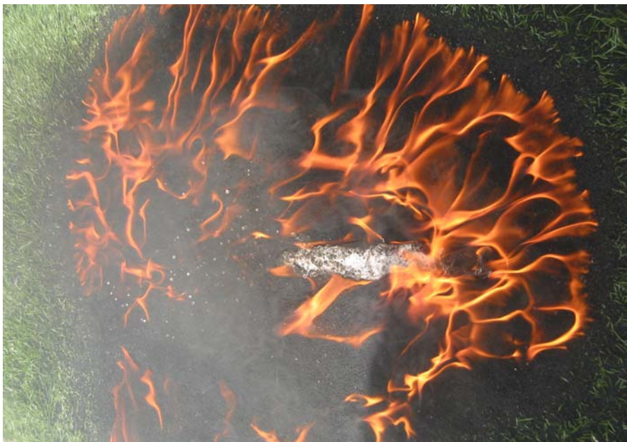
figure 2: Test with fireworks („bengalisches Feuer“) – SBR rubber infill
